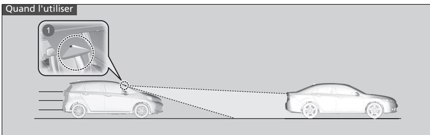
① La caméra grand angle avant se situe derrière le rétroviseur.
