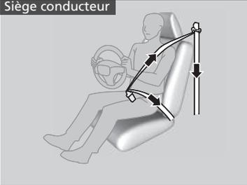
Les sièges avant et les sièges arrière extérieurs sont équipés de prétensionneurs automatiques de ceinture de sécurité en vue de renforcer la sécurité.
