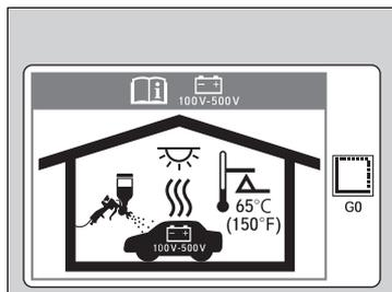
Une température élevée peut endommager la batterie haute tension utilisée pour alimenter le moteur électrique.
