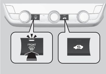
Une pression sur la touche
