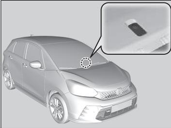
Le système de climatisation automatique est équipé de capteurs. Ne pas couvrir les capteurs ou répandre de liquide dessus.
