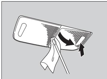
3. Déposer l'ampoule à remplacer et insérer la neuve.
