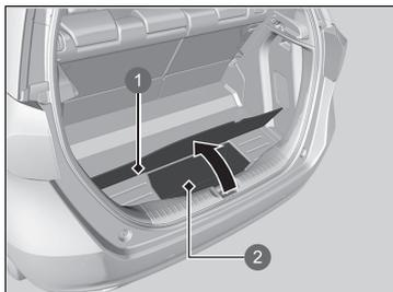
Tirer le couvercle du plancher inférieur du compartiment à bagages vers le haut.
