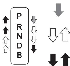
Enfoncer la pédale de frein et appuyer sur le bouton de déverrouillage du levier de vitesses pour déplacer le levier.
