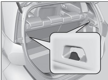
Les crochets à bagages du compartiment à bagages peuvent être utilisés pour suspendre des objets légers.
