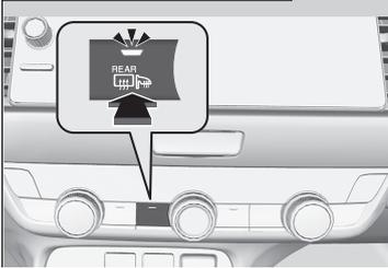
Appuyer sur la touche du désembueur arrière et du rétroviseur chauffant pour désembuer la vitre arrière et les rétroviseurs lorsque le mode d'alimentation est sur ACTIVE.
