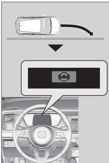
La caméra grand angle avant située derrière le rétroviseur surveille les marquages de voie à gauche et à droite, en blanc ou jaune, le bord extérieur de la chaussée (bordée d'herbe ou de gravier) ou des véhicules arrivant en sens inverse.
