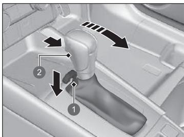
1 Fente de déverrouillage du levier de vitesses
