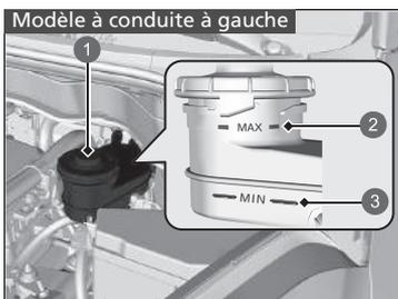
Le niveau du liquide doit se situer entre les repères **MIN** et **MAX** indiqués sur le côté du réservoir de réserve.
