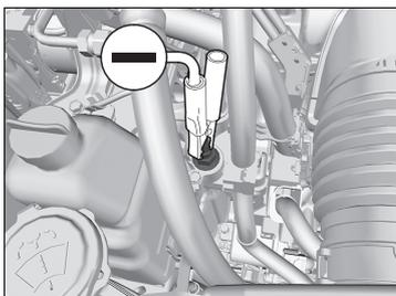
1. Ouvrir le cache de borne situé sur la borne positive  $\oplus$  de la batterie 12 V du véhicule.
