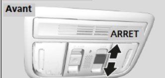
Position d'activation par les portes
